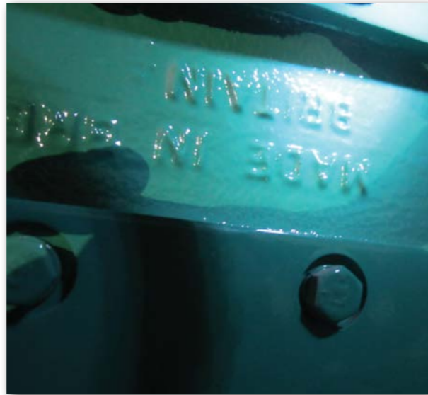
Контрафактный блок цилиндров с маркировкой "MADE IN GT. BRITAIN"
